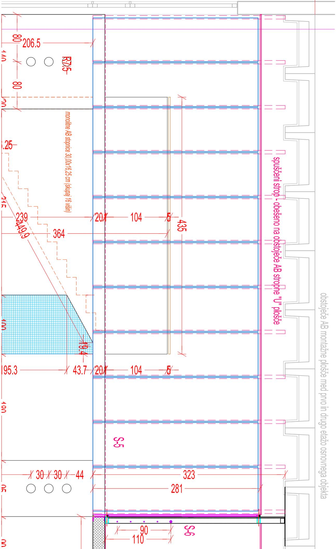
obstoječe AB montažne plošče med prvo in drugo etažo osnovnega objekta
